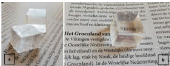
Figuur 1 a & b: IJslands spaatkristal A: foto van IJslands spaatkristal welke de opmerkelijke slijping laat zien: schuine kubussen. B: foto van IJslands spaatkristal die de naam 'dubbelspaat' toelicht: dubbele lichtbreking. Figuur 1a en 1b zijn foto's gemaakt door de auteur.
